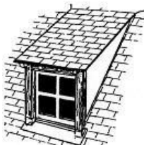
lucarne rampante ou en chien couché
