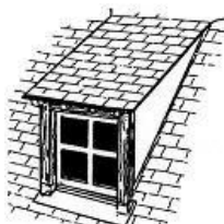
lucarne rampante ou en chien couché
