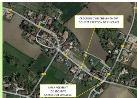
**Deux chicanes seront aménagées sur la section urbanisée afin de réduire la vitesse à l'entrée de l'agglomération.** Il sera réalisé le long de l'aménagement, une bande de stationnements longitudinaux afin de proposer une offre de stationnement supplémentaire. Ces travaux pourront être réalisés en une seule tranchée de travaux
